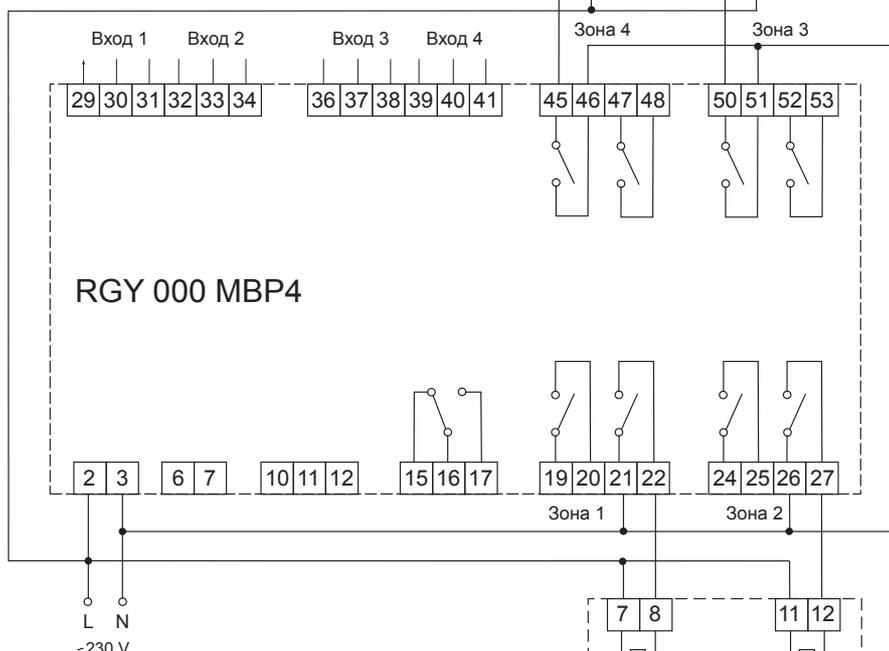
Пример подключения ACC REL 020 OSE к блоку питания и сигнализации RGY 000 MBP4 для использования с клапанами нормально-закрытого типа на 230V~
