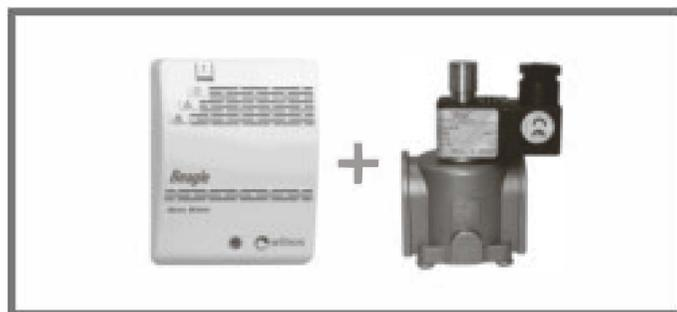
ного реле: размыкаются контакты 4–5 и замыкаются 3–5 и 6–7. Напряжение с электромагнитной катушки клапана снимается и он закрывается. При снижении концентрации сигнализатор переходит в нормальный режим работы автоматически, т.е. гаснет красный индикатор, контакты реле возвращаются в исходное положение: замыкаются 4–5, размыкаются 6–7. Однако для открытия клапана и подачи газа необходимо его снова вручную взвести, нажав кнопку взвода.
