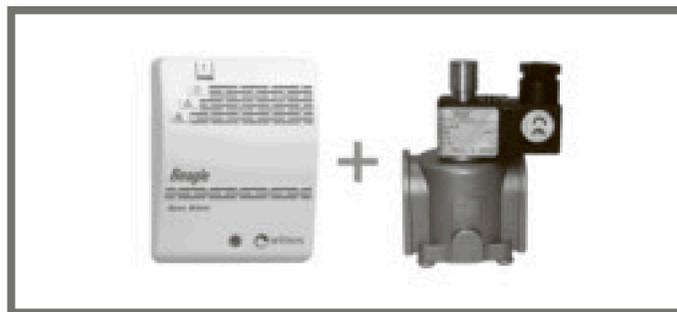
катушки клапана снимается и он закрывается. При снижении концентрации сигнализатор переходит в нормальный режим работы автоматически, т.е. гаснет красный индикатор, контакты реле возвращаются в исходное положение: замыкаются 4–5, размыкаются 6–7. Однако для открытия клапана и подачи газа необходимо его снова вручную взвести, нажав кнопку взвода.
