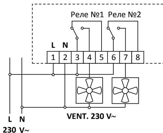
Рис.4 Электрическая схема подсоединения двух вентиляторов 230 V~.
