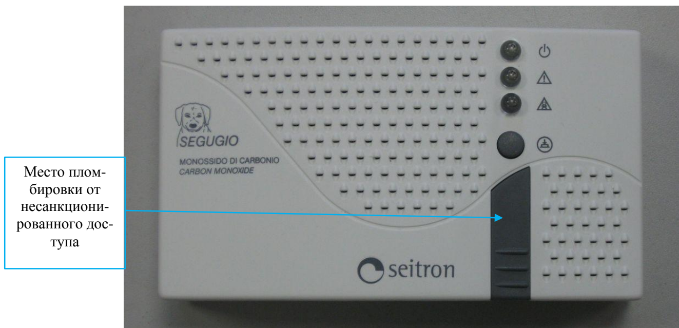
Рисунок 1 – Общий вид сигнализаторов загазованности комбинированных RGDCO0MP1 (блок питания и сигнализации)
